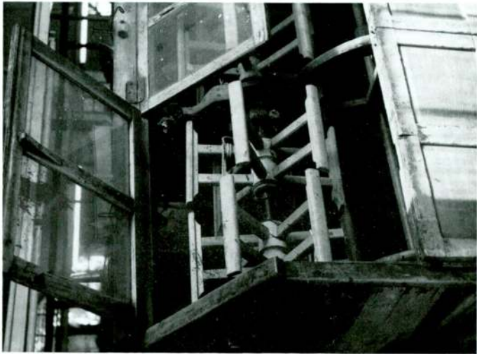
Abb. 15 Aus Holz gefertigte Haspel in einer alten Seidenspinnerei in Bursa
